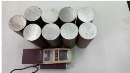
Hình 4.27: Thực nghiệm đo độ nhám khi gia công
