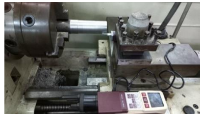
Hình 4.27: Thực nghiệm đo độ nhám khi gia công
